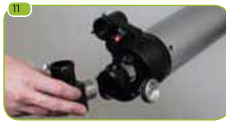
Ослабьте винты фиксаторов окулярного адаптера, а так же снимите крышку с адаптера. Установите диагональное зеркало.
