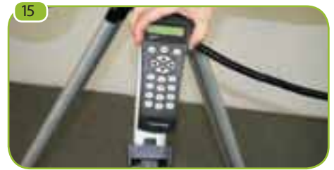
Установите пульт управления в держатель. Пульт управления LCM оснащен кабелем с разъемом телефонного типа.
