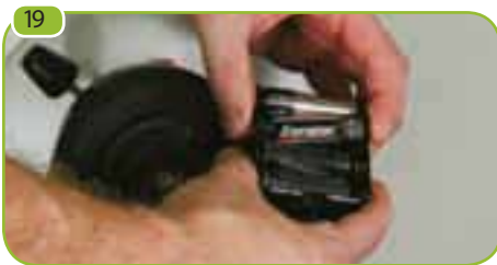
Вставьте 8 батареек типа AA в держатель.
