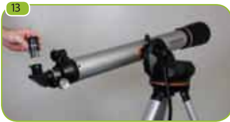
Установите 25-мм окуляр хромированной частью в диагональное зеркало. Зафиксируйте окуляр винтом.
