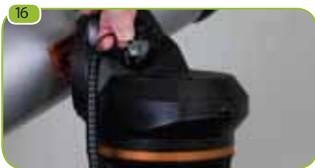
Вставьте его в гнездо порта "Hand Control", расположенное в основании монтировки телескопа так, чтобы он защелкнулся.
