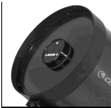
Рис. 7-3. Три юстировочных винта на оправе вторичного зеркала.
