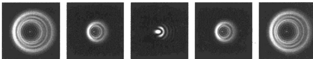
Рис. 7-4 Дифракционная картина асимметрична, затемнение смещено влево. Требуется юстировка.
